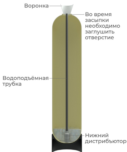
Заполнение фильтра материалом
