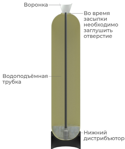
Заполнение фильтра материалом
